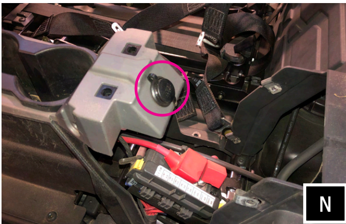
N. Disconnect the 12V socket.
